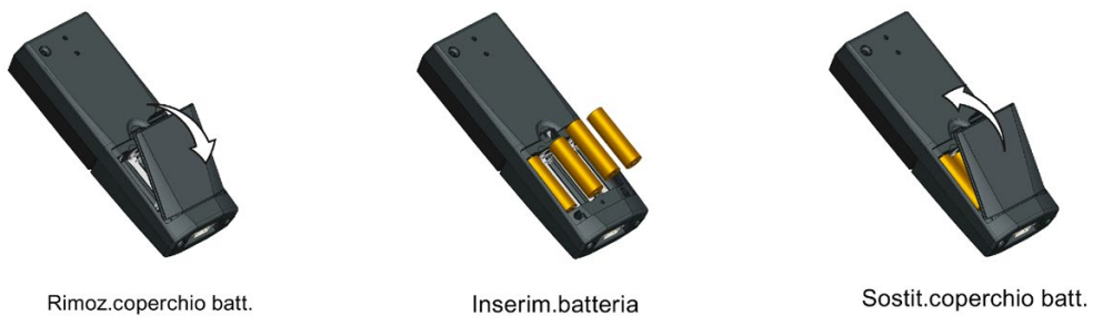
Figura 9-5 Installazione delle batterie per il kit Hand-held
